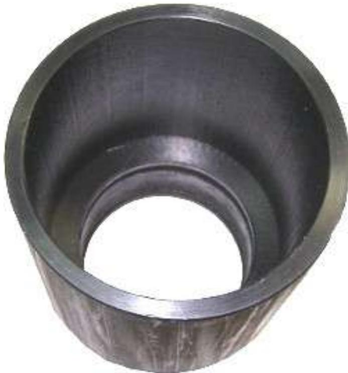
Рисунок Д.18 - Ячейка калибровочная для поверки и регулировки погружных датчиков
