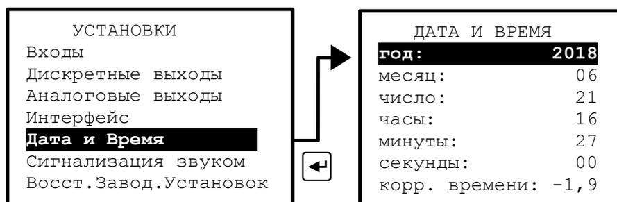
Рисунок 22 - Настройка встроенных часов реального времени
