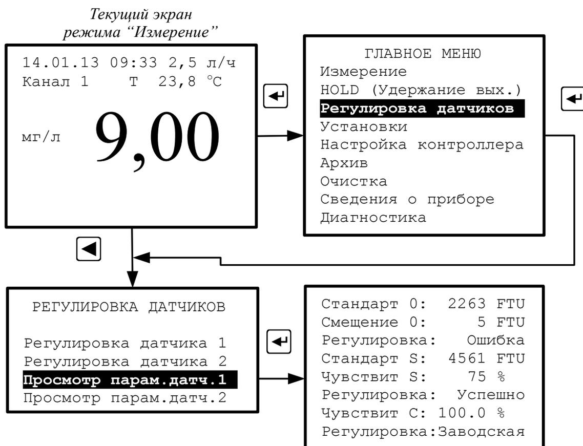
Рисунок 15 - Просмотр параметров датчика
