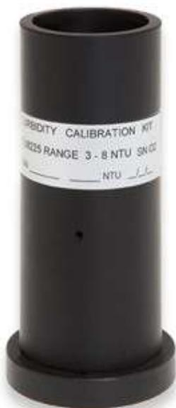
Рисунок Д.13 - Устройство TU 9632 для настройки/калибровки проточных датчиков мутности менее 20 NTU (сухой стандарт)
